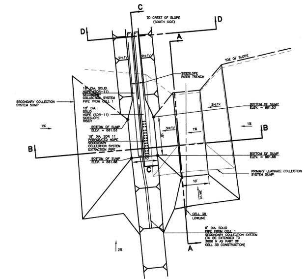
**CELL 3B SECONDARY COLLECTION SYSTEM SUMP PLAN**
