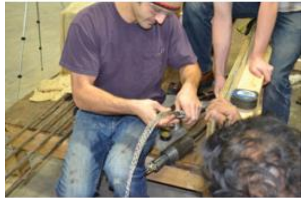
(d) Additional braided steel wire netting
