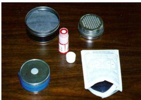
**Kits de prueba de corto plazo:** Una prueba de corto plazo mide los niveles de radón para 2 - 7 días y es una forma rápida de comprobar la presencia de radón en un hogar. Cuando realiza una prueba de radón debe comenzar con una prueba de corto plazo.
