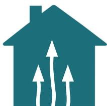
**Efecto acumulativo:** El aire cálido sube hacia la parte superior del hogar y se pierde hacia el aire exterior. El aire de reemplazo entra en la parte inferior del hogar, parte del aire de reemplazo viene del suelo.
