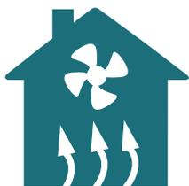
**Efecto de vacío:** Los dispositivos domésticos (calentadores de agua, chimeneas, secadores de ropa, hornos antiguos etc.) y los extractores retiran el aire del hogar. Esto puede atraer el gas del suelo hacia dentro del hogar cuando el aire de reemplazo entra en la parte inferior de la casa.
