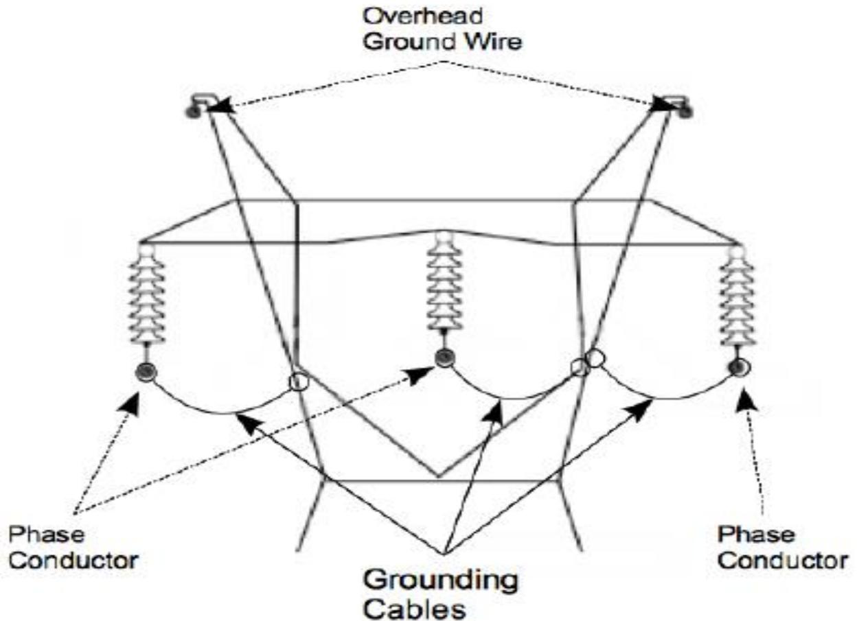
**Figure 4 – Equipotential Zone for Metal Lattice Tower**
