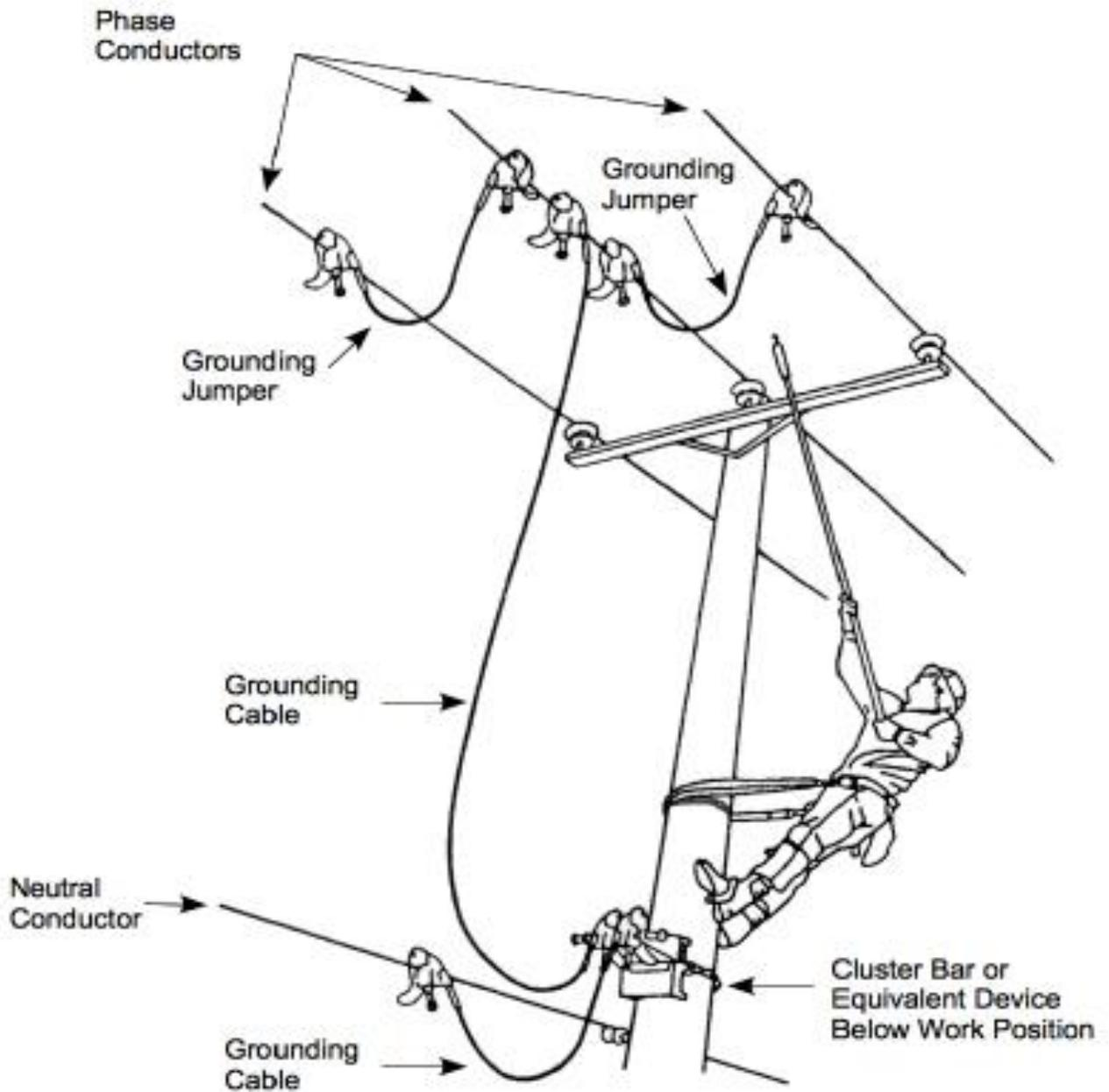
**Figure 5 – Equipotential Ground for Wood Poles**
