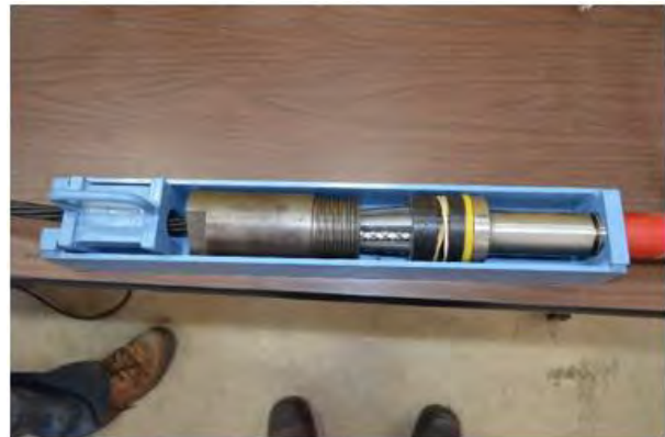
(d) Sliding steel wedges using hand pump
