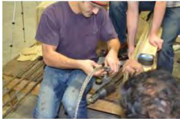
(d) Additional braided steel wire netting
