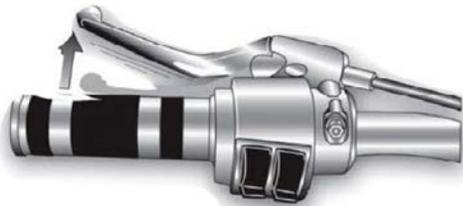
**Zone de friction** - le point de l'embrayage où la puissance du moteur commence à se transmettre à la roue arrière.
